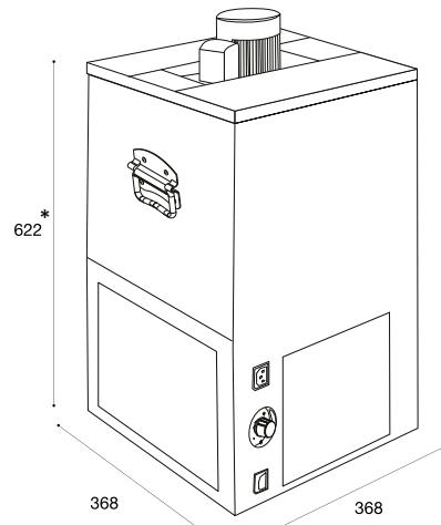
\*702mm (altezza con pompa/height with pump)
