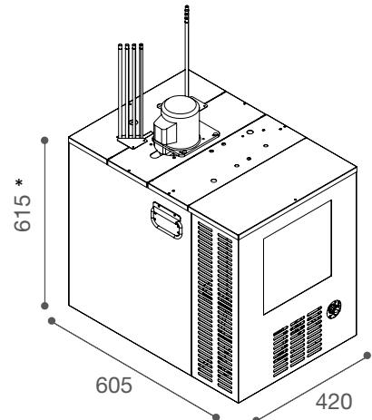
\*617mm (altezza con pompa/height with pump)
