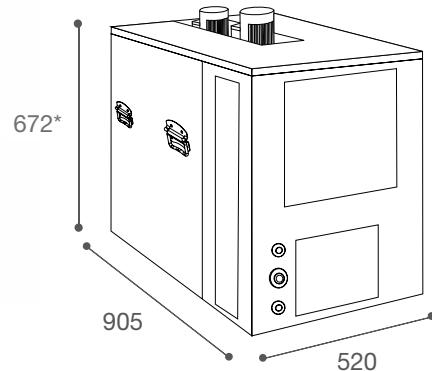
\*752mm (altezza con pompa)/height with pump)
