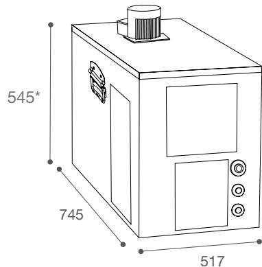
\*625mm (altezza con pompa/height with pump)
