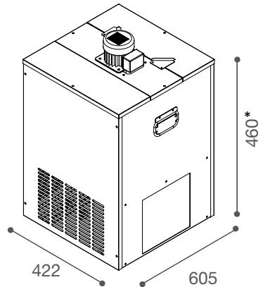
\*690mm (altezza con pompa/height with pump)
