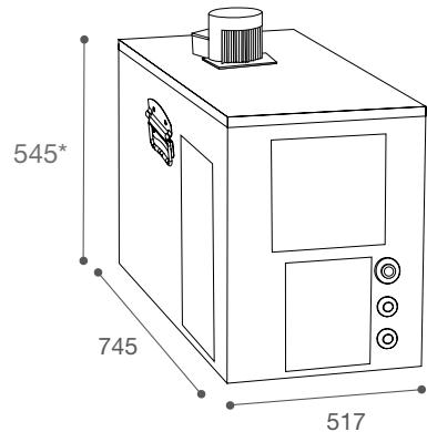
\*625mm (altezza con pompa/height with pump)
