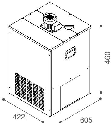
\*690mm (altezza con pompa/height with pump)
