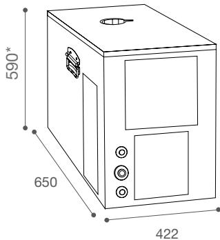
\*670mm (altezza con pompa/height with pump)
