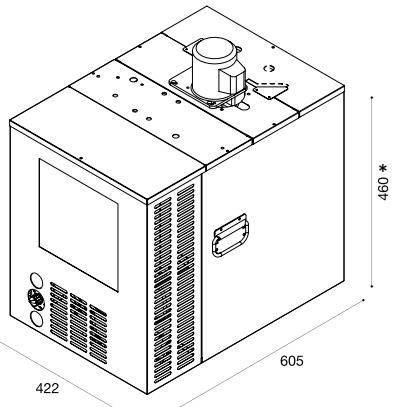
\*540mm (altezza con pompa/height with pump)
