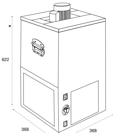
\*702mm (altezza con pompa/height with pump)
