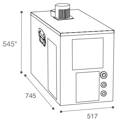
\*625mm (altezza con pompa/height with pump)
